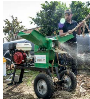
Picadora funcionando con biogás
