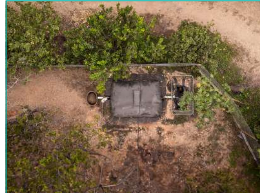
Sistema 8 Área Requerida: 8.5 x 4.0 m Biogás: 2.4 m 3 /día*
