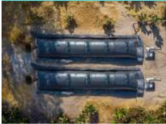
Sistema 60 Área Requerida: Sis 30 x 2 Biogás: 20 m 3 /día*
