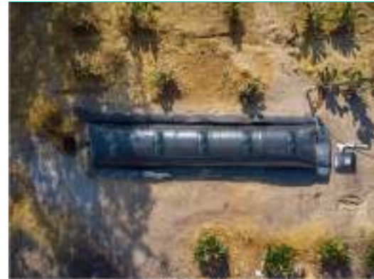
Sistema 30 Área Requerida: 3.4 X 15.7 m Biogás: 10 m 3 /día*
